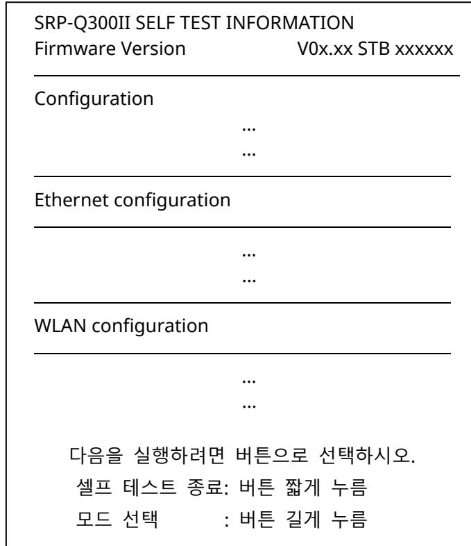
셀프 테스트 인쇄가 완료되면 버튼을 길게 눌러 “모드 선택”으로 진입합니다.
