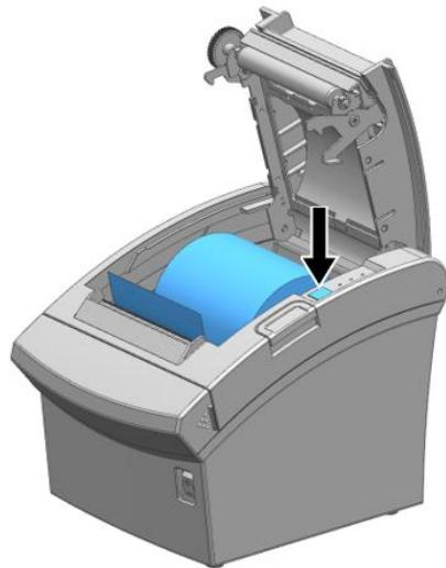
3) 프린터 커버를 닫으면 내부 버저가 5회 울리며 인터페이스 설정 확인 모드로 진입합니다.
