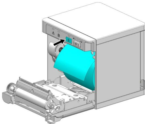
3) 프린터 커버를 닫으면 인터페이스 설정 확인 모드로 진입합니다. 설정정보는 SELF TEST INFORMATION의 “Ethernet configuration”, “WLAN configuration”에서 확인할 수 있습니다.
