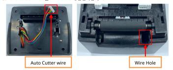
6. Auto Cutter Wire 를 방향에 맞추어 Auto Cutter Connector(빨간색 사각형)에 삽입하십시오. Peeler Connector **Auto Cutter Connector**
